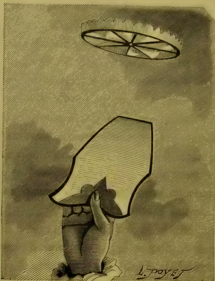
Fig. 234. Spirale di carta messa in rotazione per mezzo di un parafuoco.
